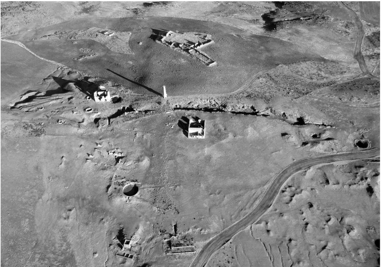
Figura 1. Mina La Solana: Foto aérea mostrando la casa de bombeo (a la izquierda de la chimenea) y la de extracción (centro). Fuente: <http://hinosaparamotor.blogspot.com.es/>
